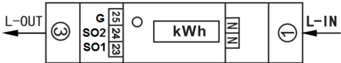
Hinweis: 23: SO-1 ist der SO-Ausgang für kWh oder aktive/reaktive Import-kWh optional
